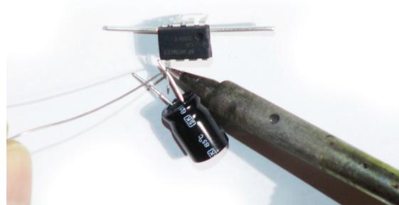
Zurecht biegen des Outputs (Pin 5) und verlöten des Kondensators.
