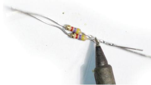
Vorbereiten der 4,7kOhm Widerstände mittels Verdrillens und Verlöten einer Seite.
