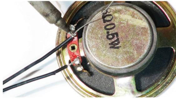
Anschluss des Lautsprechers an den Minuspol des Kondensators und den Massebus.
