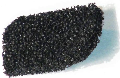
Als ESD-Schaum (ESD = electro static discharge) bezeichnet man einen schwach leitfähigen, da mit Metalloxid versetzten, schwarzen Schaumstoff.
