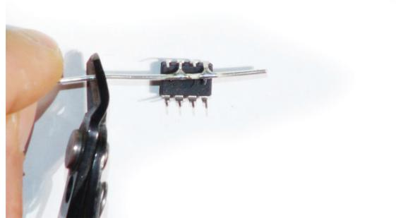
Festlöten und auf Überlänge abschneiden des Masse- (Ground) Busses an Pin 2 und 4.
