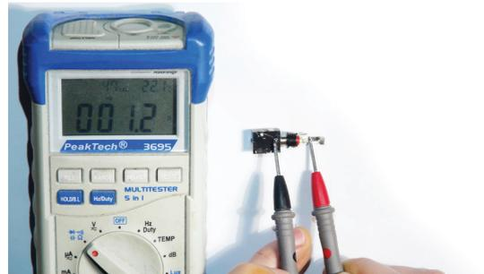
Vorbereiten der Eingangsbuchse. Durchgangsprüfung mittels Multimeter und offenem Stecker um die entsprechenden Pins zu lokalisieren.
