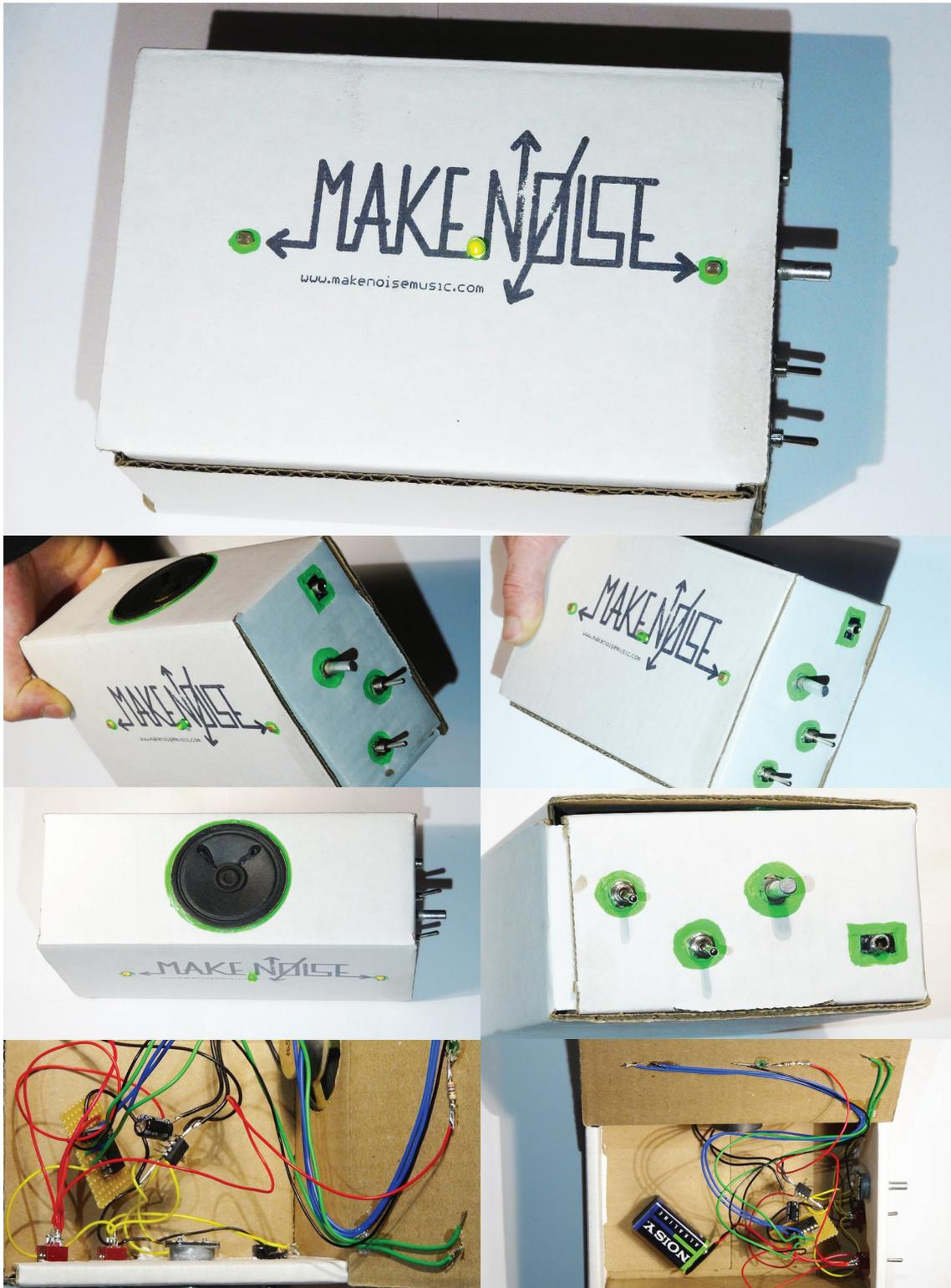
Das Resultat beider Teile des Unterrichtskonzepts. Die Verstärkerschaltung mit Klinkeingang zusammen mit der Grundschaltung des optischen Theremins in einem Gehäuse aus Karton.
