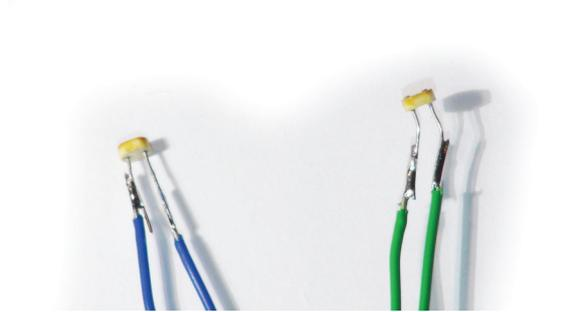
Anlöten der Lichtsensoren an die entsprechenden Anschlussdrähte.
